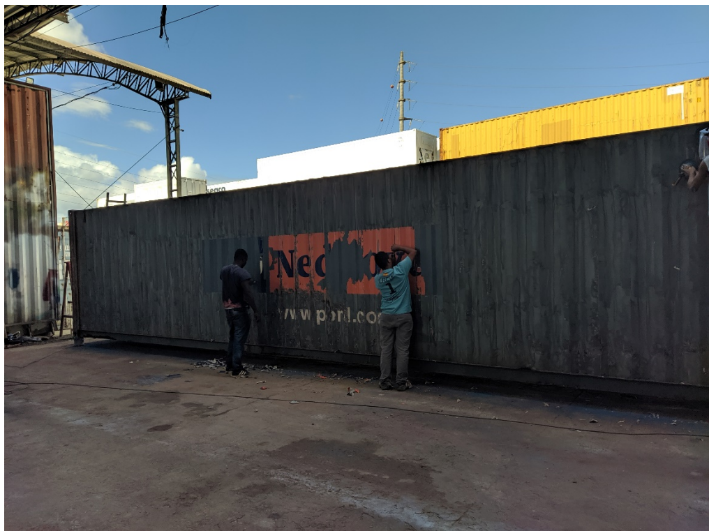
FIGURA 9 - LIXAMENTO DE ADESIVOS DA SUPERFÍCIE EXTERNA
