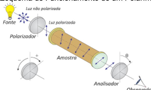
Figura 11 -Esquema de Funcionamento de um Polarímetro
