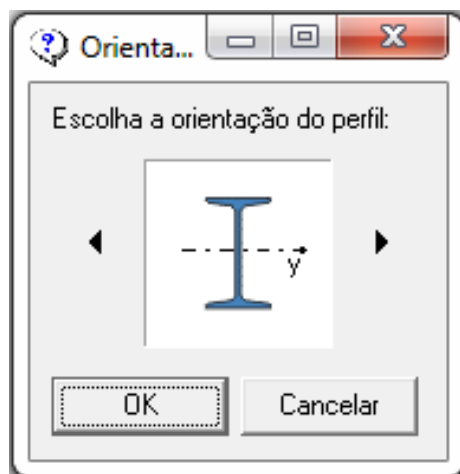
Figura 28 - Janela para escolha da orientação do perfil (mCalc 3D 4.0)
