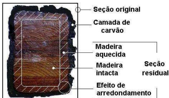
Figura 6 – Seção de uma viga de madeira laminada colada, exposta ao fogo durante 30 minutos
