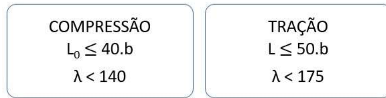
Figura 21 – Dimensões limites para estabilidade de peças
