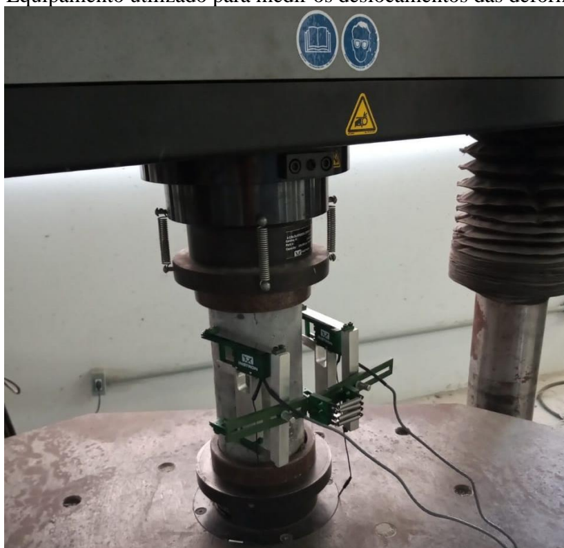
Figura 4. 10 - Equipamento utilizado para medir os deslocamentos das deformações – LVDT
