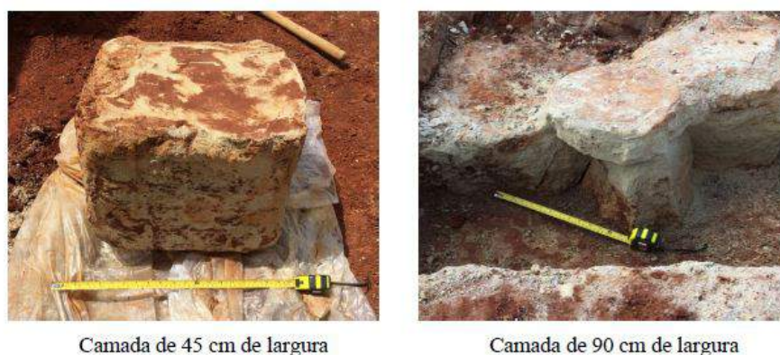
Figura 2.32 – Mecanismo de ruptura das camadas estabilizadas após ensaios de prova de carga (Consoli et al. (2019)).
