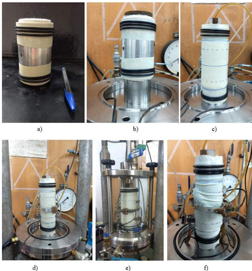
Figura 4.18 – Montagem Triaxial: a) colocação membrana e o’rings; b) colocação da pedra pososa e papel filtro; c) posicionamento do top cap; d) colagem dos sensores de deslocamento; e) fechamento da câmara; e) amostra ao final do ensaio.
