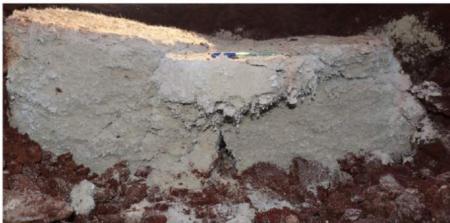
Figura 5.12 – Ruptura camada Dr90 Sem Álcali a) vista superior; b) vista frontal
