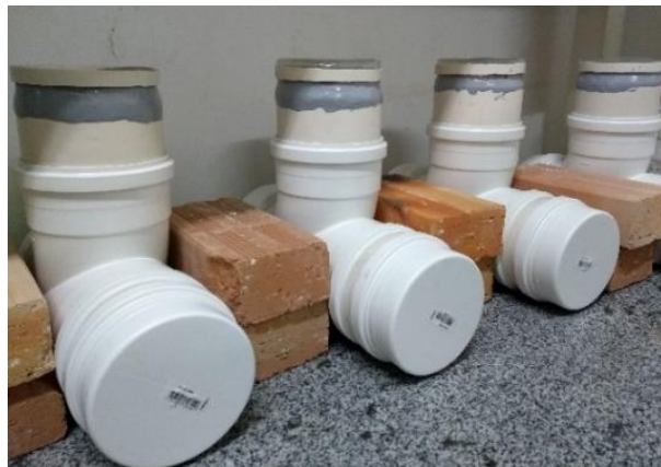
Figura 36 - Fixação do corpo de prova de concreto na primeira célula do aparato de ensaio
