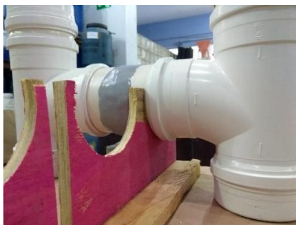
Figura 38 - Secagem completa do aparato de ensaio com apoio em gabarito de madeira
