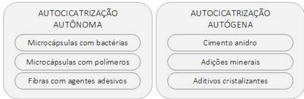
Figura 2 - Tipos de autocicatrização em materiais cimentícios
