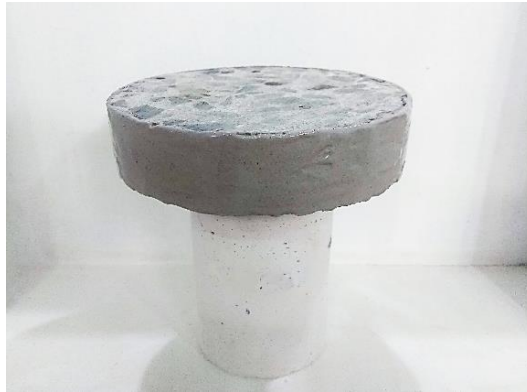
Figura 32 - Faces impermeabilizadas com epóxi
