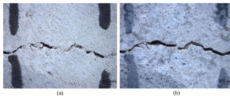
Figura 62 - Imagem de microscopia para a zona 6 do 01-Z-6C (a) 3 dias (b) 84 dias
