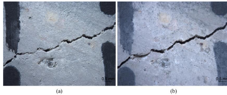
Figura 51 - Imagem de microscopia para a zona 9 do 02-X-2C (a) 3 dias (b) 28 dias
