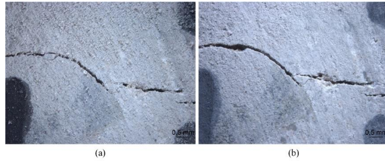
Figura 60 - Imagem de microscopia para a zona 6 do 03-Z-2C (a) 3 dias (b) 28 dias
