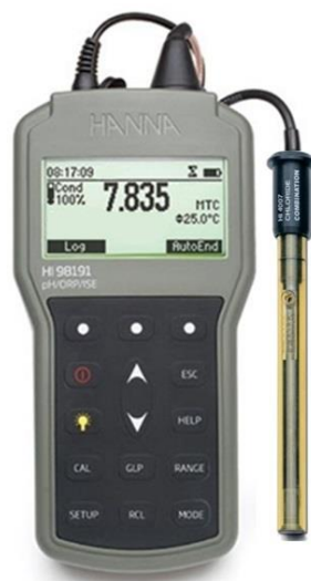
Figura 40 - Equipamento para leitura do teor de cloretos
