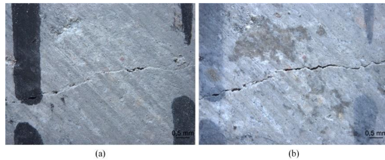
Figura 53 - Imagem de microscopia para a zona 2 do 01-X-6C (a) 3 dias (b) 84 dias
