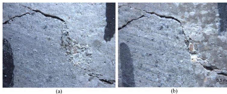
Figura 66 - Imagem de microscopia para a zona 5 do 01-SA-6C (a) 3 dias (b) 84 dias
