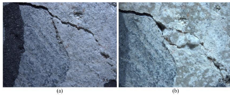
Figura 49 - Imagem de microscopia para a zona 8 do 02-REF-6C (a) 3 dias (b) 84 dias
