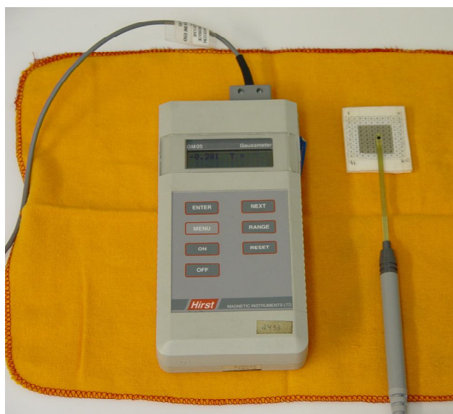
Figura 46 Teslímetro, ponteira transversa e gabaritos de posicionamento
