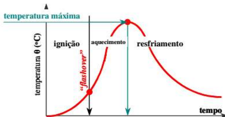
Figura 1: Curva de incêndio real simplificada
