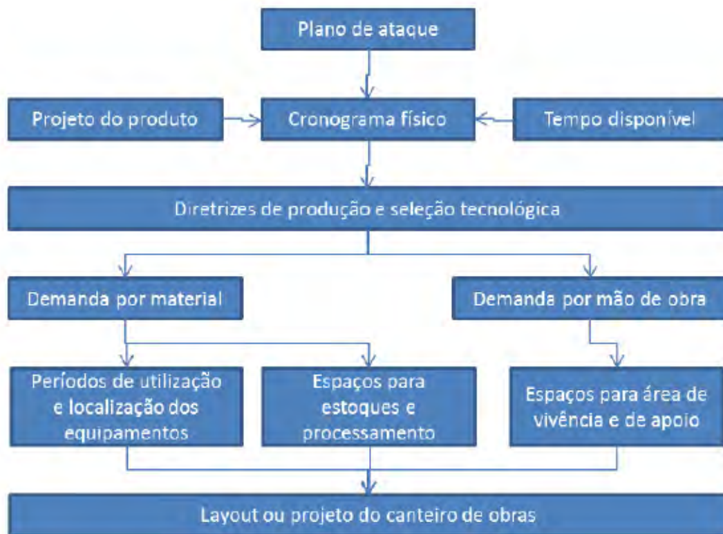
Figura 4-11-1. Fluxograma das atividades necessárias para o processo de concepção do projeto do canteiro de obras.
