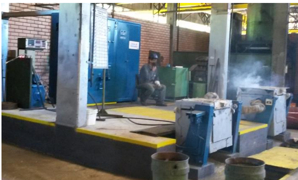
Figura 27: Forno à indução utilizado para fusão dos corpos de provas. Fonte: próprio autor.
