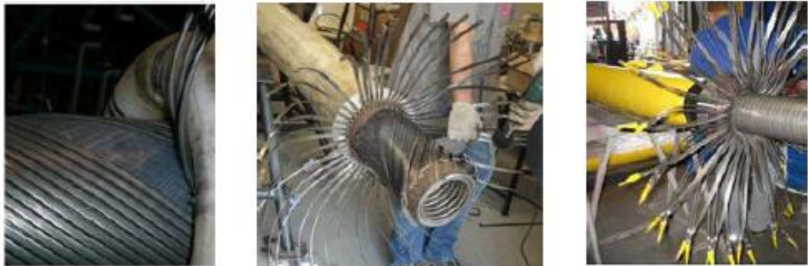
Figura 6 - Dobramento dos fios da armadura de tração.
