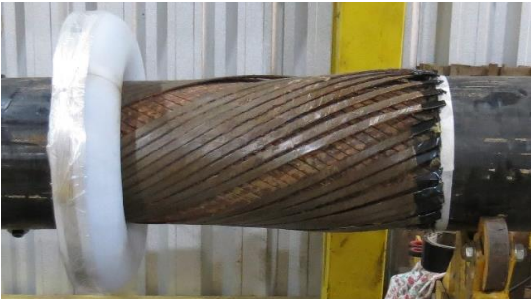
Figura 16 - Posicionamento do gabarito de controle de curvatura.
