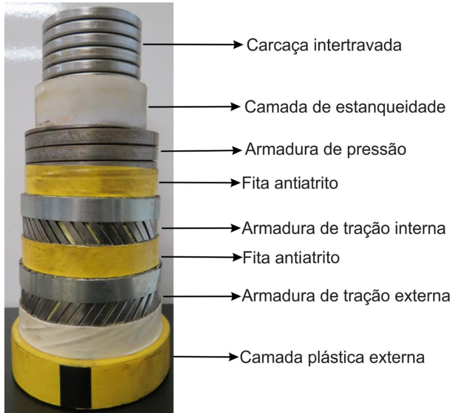
Figura 2 - Camadas de um duto flexível típico.
