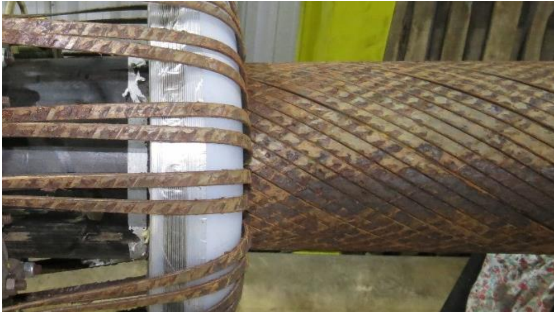
Figura 17 - Primeira etapa de dobramento sobre o gabarito de controle de curvatura.
