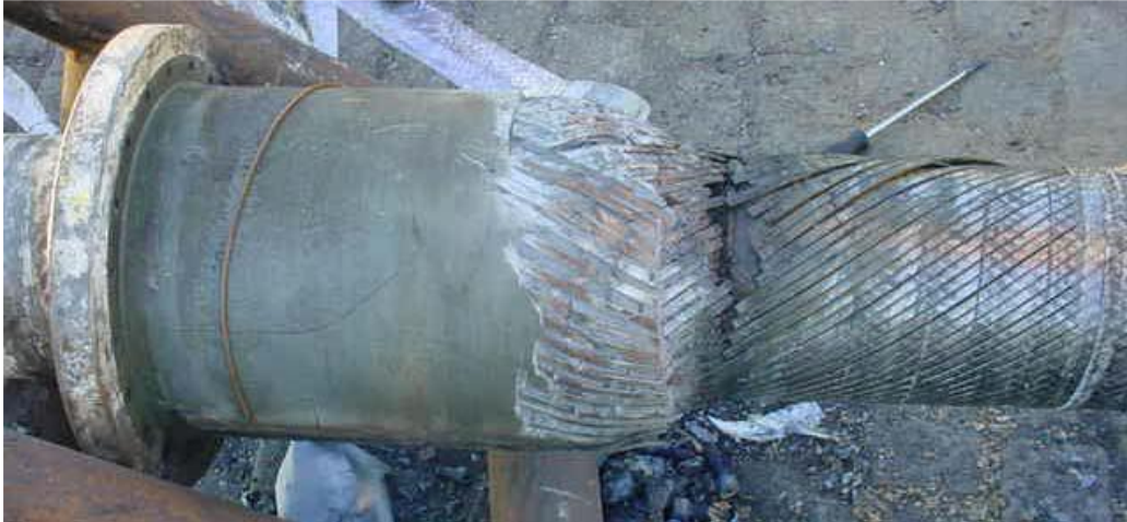
Figura 8 - Armadura de tração rompida próximo ao conector.
