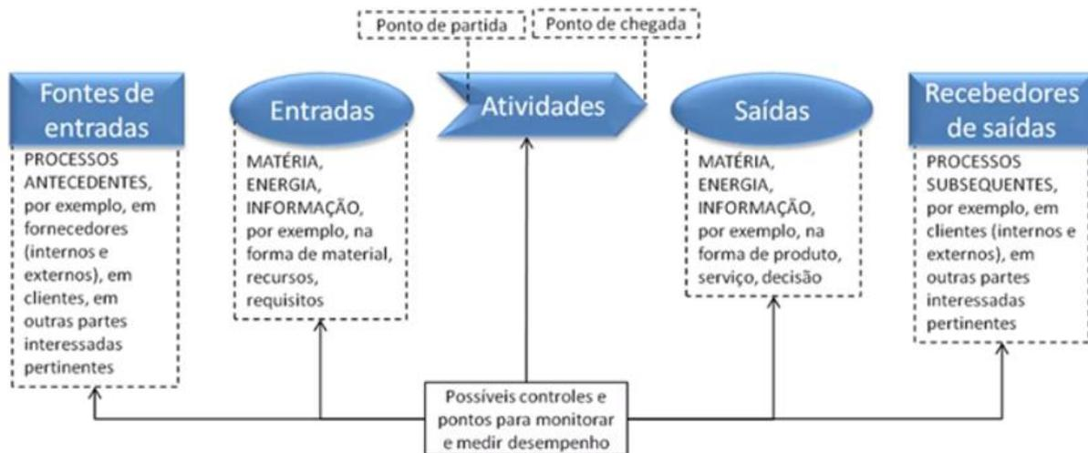
**Figura 1: Representação esquemática de um processo**
