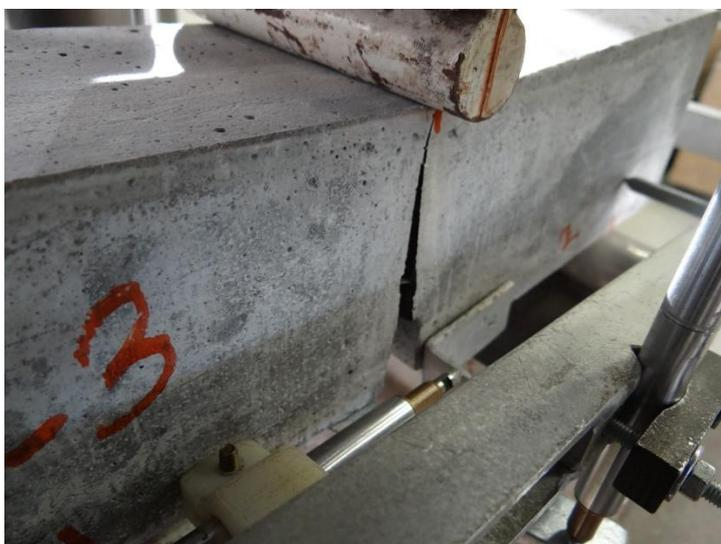
Figura 3.2–Situação da viga de CUADRF após ruptura. Fonte: Rojas (2019).
