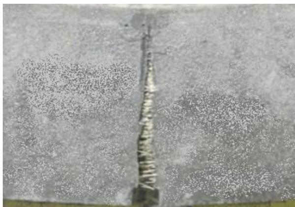
Figura 2.3 – Exemplo experimental de viga com fibras de aço após falha. Fonte: Adaptado de Yoo et al. (2013).
