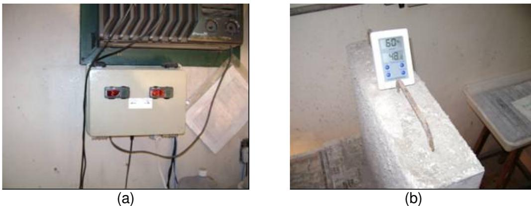
Figura 37: cura com temperatura elevada: (a) detalhe do equipamento de controle ambiental e (b) medição
