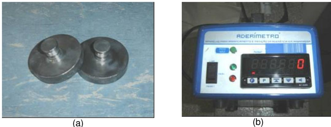
Figura 48: (a) pastilhas e (b) aderímetro utilizados no experimento
