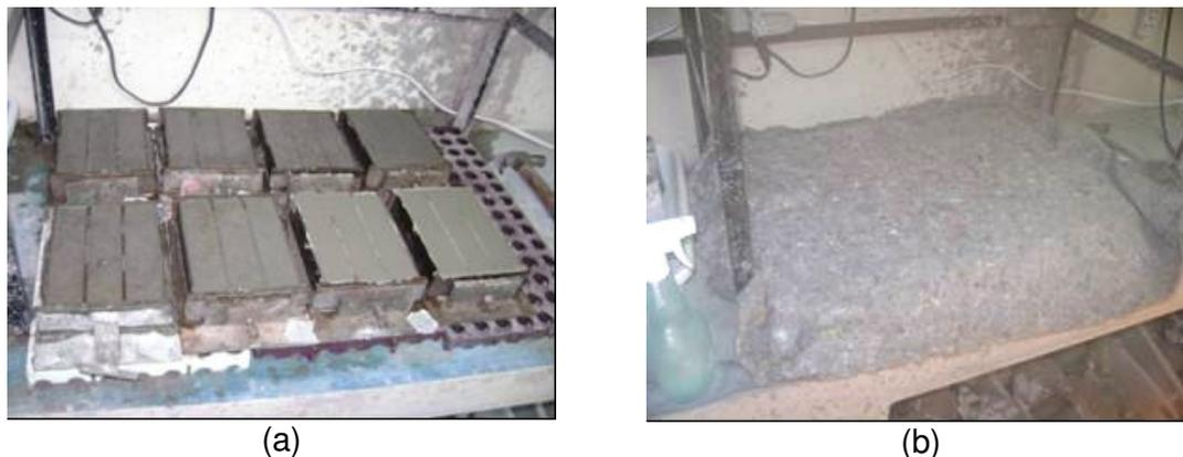
Figura 44: corpos-de-prova das argamassas de chapisco submetidos a: (a) cura ambiente e (b) úmida
