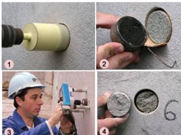
Figura 11: passos do ensaio de resistência de aderência: (1) corte; (2) colagem da pastilha; (3) medição da carga de ruptura e (4) verificação da região de ruptura (REVISTA TÉCNICA, 2008)
