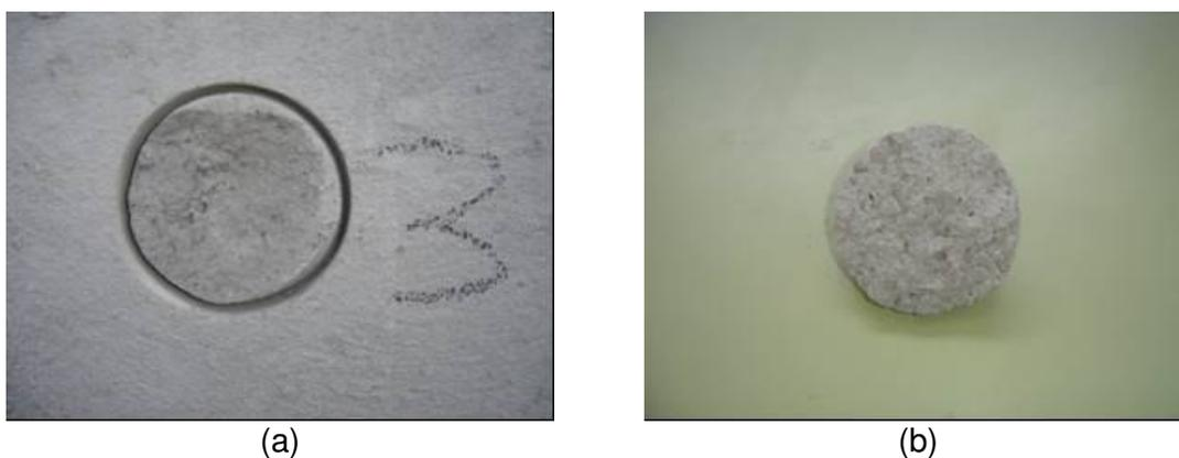
Figura 17: aspecto superficial de (a) furo e (b) respectivo c.p. em exemplo de ruptura na argamassa de emboço
