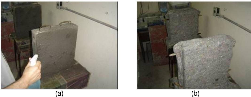
Figura 36: (a) umedecimento e (b) cobertura das amostras com manta molhada
