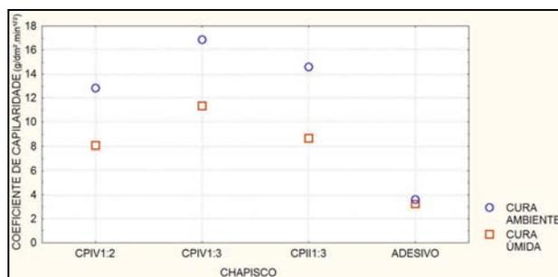
Figura 65: influência do tipo de cura e tipo de chapisco nos coeficientes de capilaridade das argamassas de chapisco
