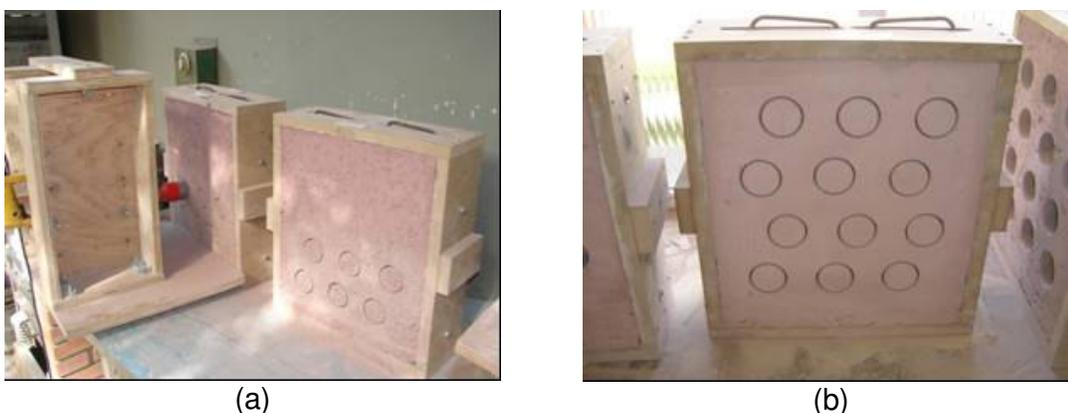
Figura 47: (a) realização dos furos e suporte para apoio da furadeira e (b) painel já preparado
