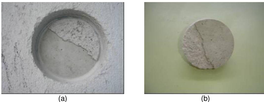
Figura 18: aspecto superficial de (a) furo e (b) respectivo c.p. de ruptura ocorrida parte na interface substrato de concreto/chapisco e parte na interface chapisco/emboço
