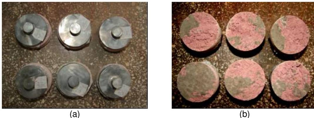
Figura 51: exemplos de (a) pastilhas arrancadas e (b) suas seções de ruptura
