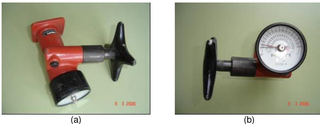
Figura 15: equipamento utilizado na medição da resistência de aderência pela CIENTEC/RS: (a) vista geral e (b) marcador de carga
