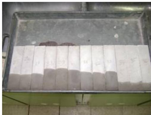
Figura 62: exemplo de amostras de diferentes tipos de argamassas de chapisco curadas com umidade a  $23\pm 2^{\circ}\text{C}$  após ensaio de absorção por capilaridade
