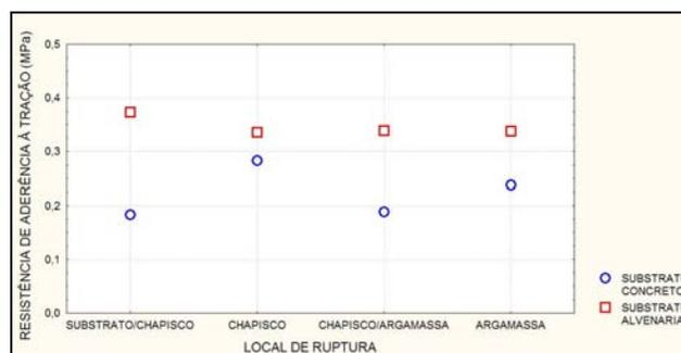
Figura 20: efeito do local de ruptura e substrato nos resultados de aderência
