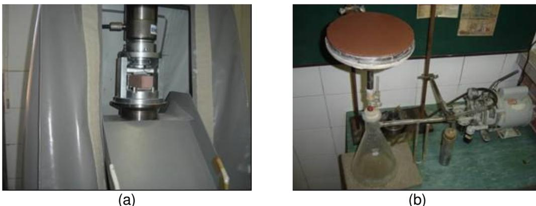
Figura 43: ensaio de (a) resistência à tração e (b) retenção de água da argamassa de revestimento
