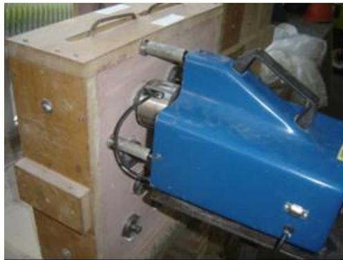
Figura 67: ensaio de resistência de aderência à tração na flexão do experimento
