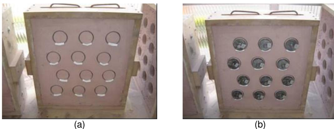
Figura 49: (a) preparação e (b) pastilhas metálicas prontas para ensaio de aderência
