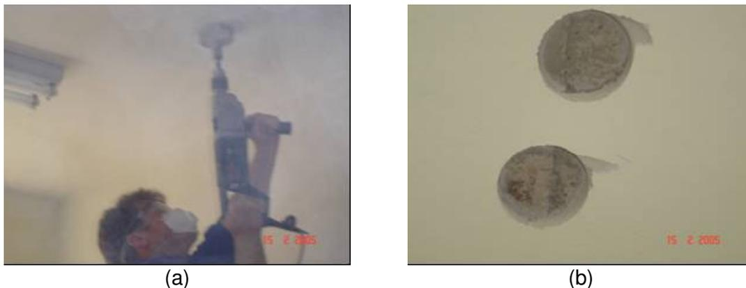
Figura 14: verificação em revestimento de teto: (a) realização de furo e (b) após ensaio
