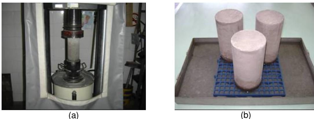
Figura 42: ensaio de caracterização do concreto dos substratos: (a) resistência à compressão e (b) absorção por capilaridade
