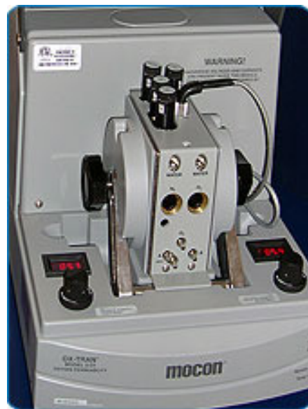
Figura 4-6: Fotografia do Equipamento Ox -Tran ® 2/21 para medida da taxa de transmissão de \text{O}_2 .
