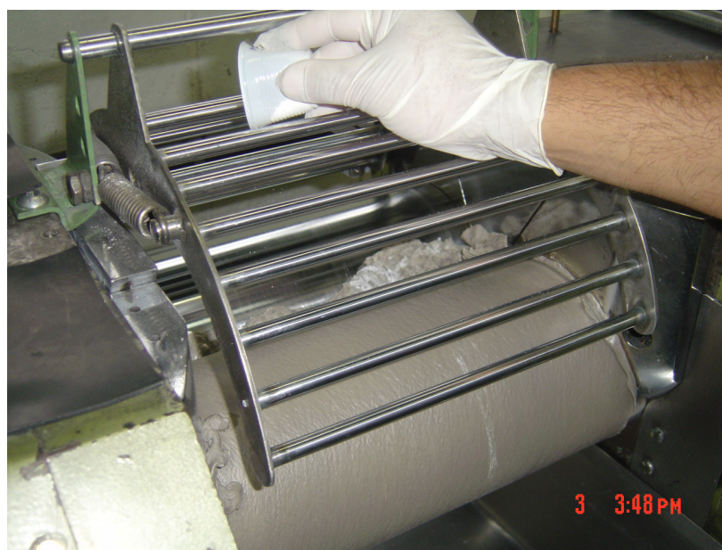
Figura 4-3: Fotografia do misturador aberto utilizado na preparação dos nanocompósitos de SBR/OMMT.
