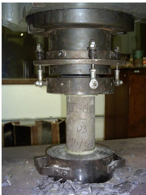
**Figura 21 - Ensaio de resistência à compressão axial**
