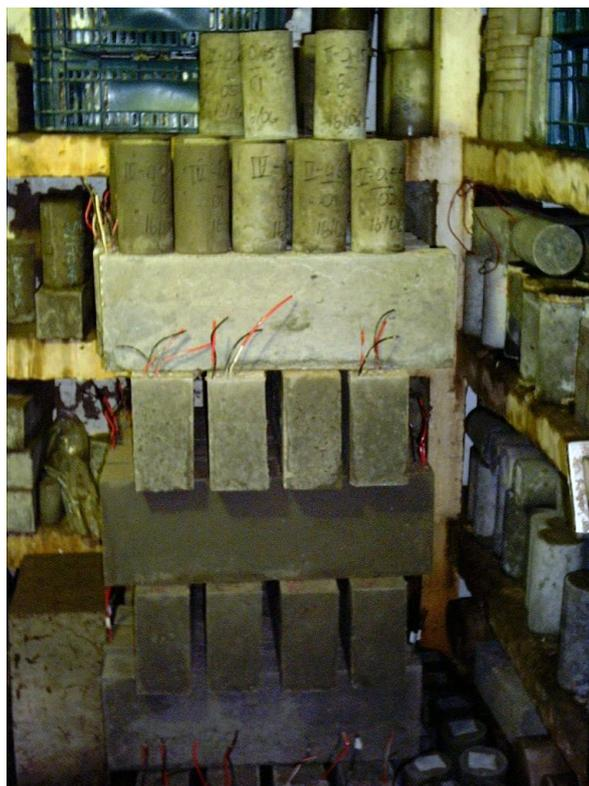
**Figura 19 - Cura de blocos e corpos-de-prova em câmara úmida**
