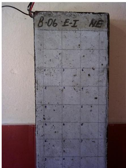
**Figura 31 - Marcação de grade de referência no bloco de concreto**
