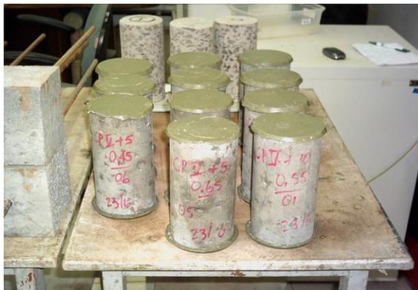
**Figura 20 - Capeamento de corpos-de-prova para ensaio de resistência à compressão axial**
