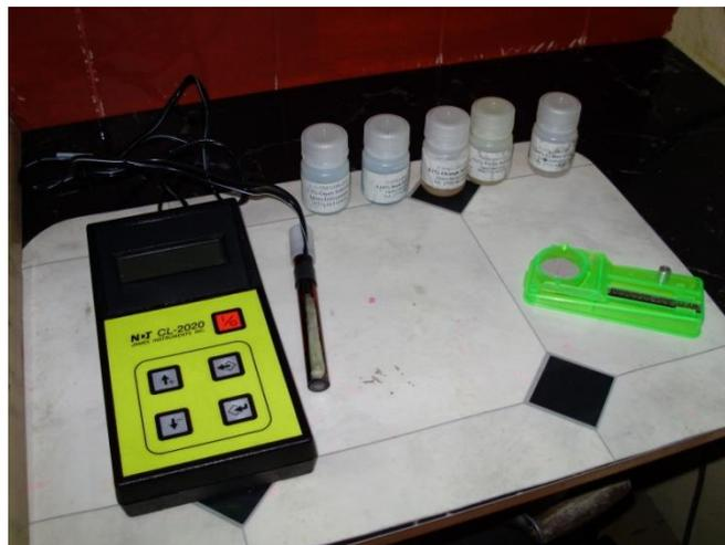
**Figura 32 - Laboratório portátil para análise de amostras: Sistema CL-2000 de Ensaio de Cloretos Para Uso em Obras, da NDT JAMES INSTRUMENTS INC.**
