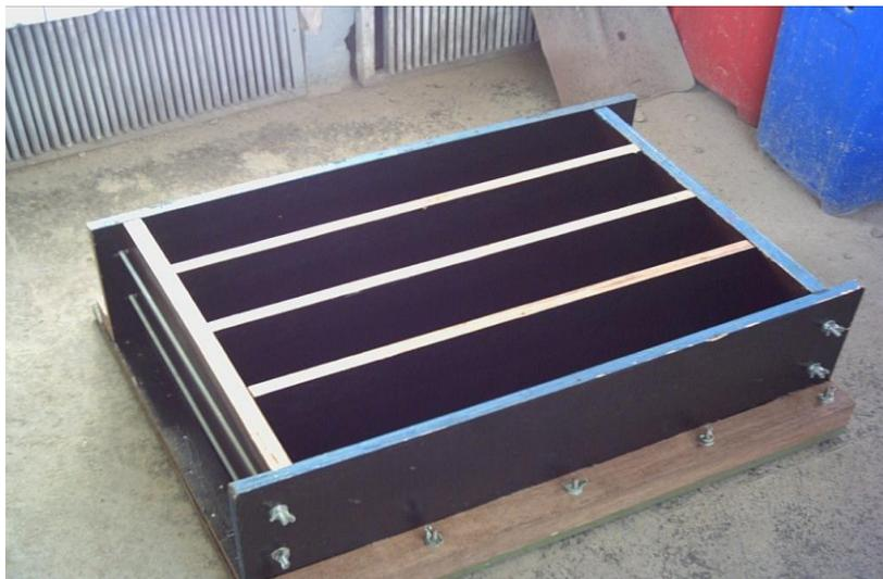
**Figura 16 - Fôrmas de compensado naval para concretagem dos blocos**
