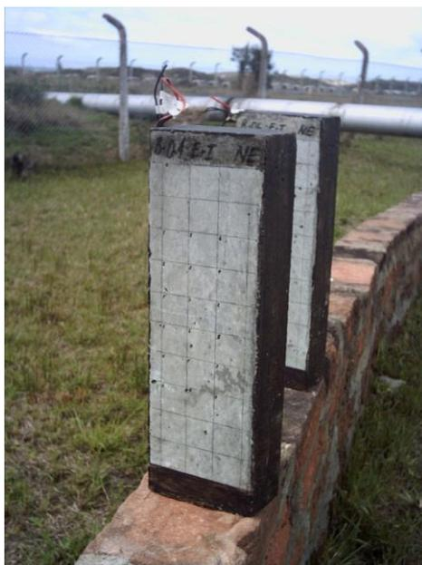
**Figura 22 – Impermeabilização das faces não trabalhadas do bloco de concreto**
