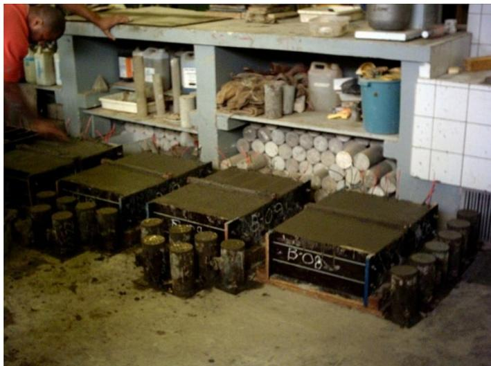
**Figura 18 - Concretagem dos blocos e corpos-de-prova**
