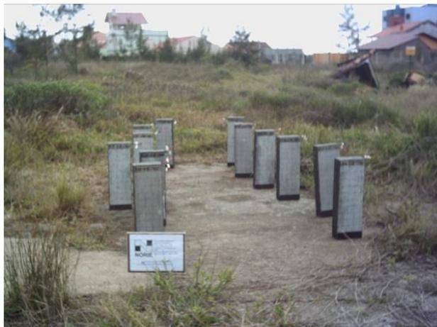
**Figura 27 - Instalação dos blocos de concreto na estação de monitoramento II**
