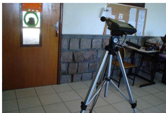
Figura 63: medidor de nível de pressão sonora, no momento das medições internas – sala de aula E
