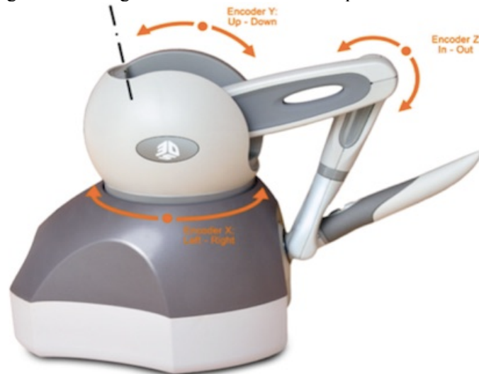
Figura 5 – Seis graus de movimento do dispositivo Touch
