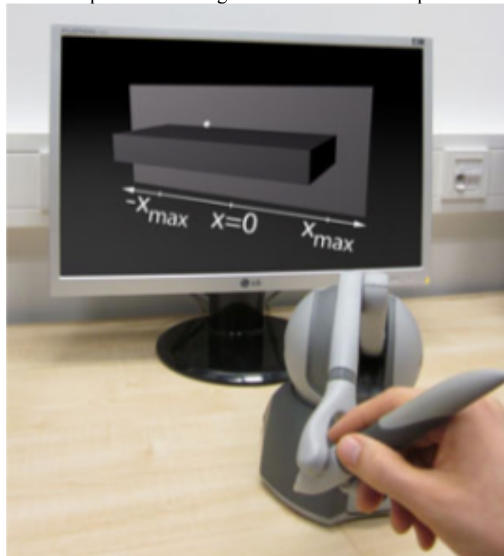
Figura 12 – Os cubos são explorados ao longo da aresta de corte no plano frontal horizontalmente
