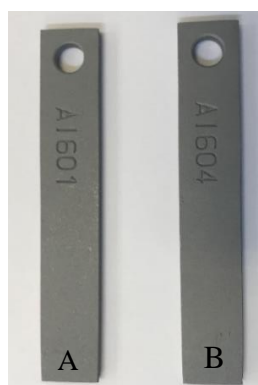
Figura 13 – Cupons de corrosão.
