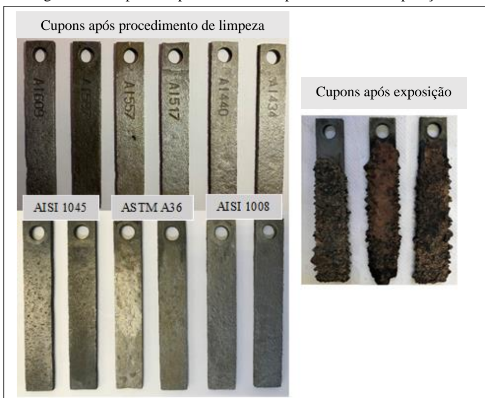
Figura 41 – Cupons de perda de massa após 180 dias de exposição.
