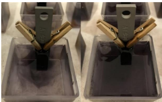
Figura 63 – Detalhe da camada preto azulado formada no ensaio com Tanino.
