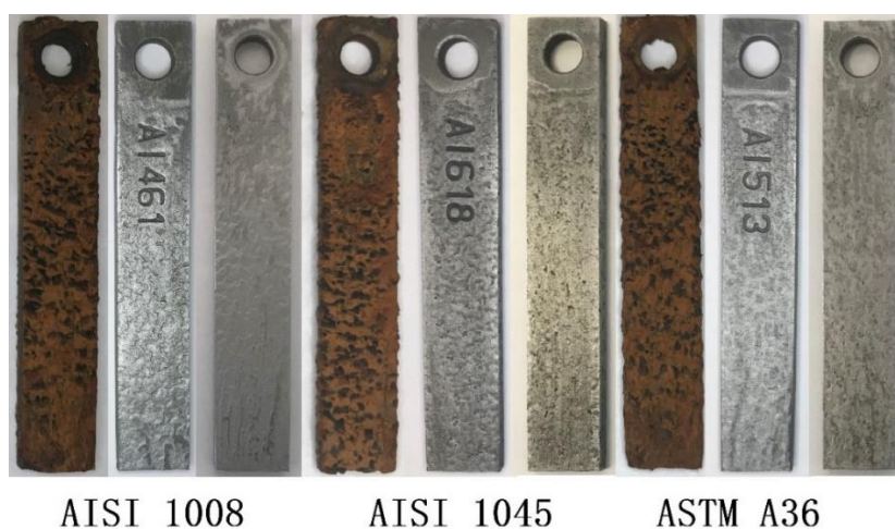
Figura 40 – Cupons de perda de massa após 27 dias de exposição.
