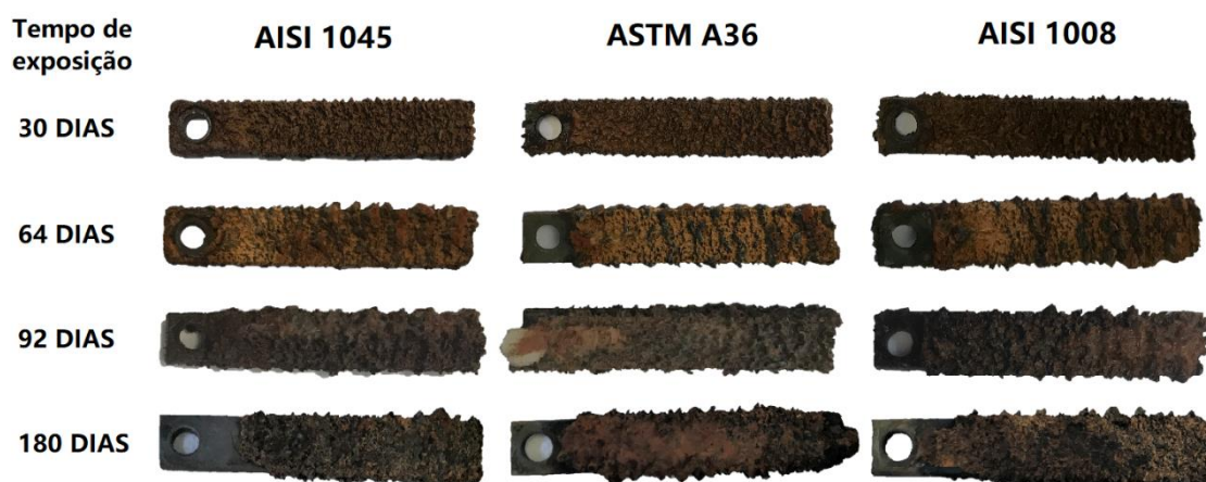
Figura 39 – Evolução da corrosão dos cupons de aços carbono com diferentes tempos de exposição.
