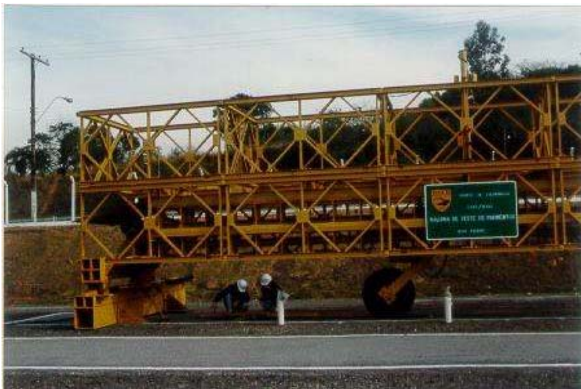
FIGURA 5.2 - Determinação da Deflexão com a Viga Benkelman
