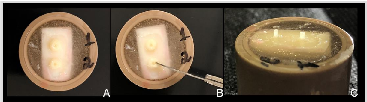
Figura 13 – Envelhecimento dos espécimes e remoção do tubo de amido. (A) aspecto dos tubos de amido após 24h de envelhecimento. (B) remoção dos tubos por meio de cortes com lâmina de bisturi nº 12. (C) espécimes expostos e prontos para o teste de resistência de união ao microcisalhamento.
