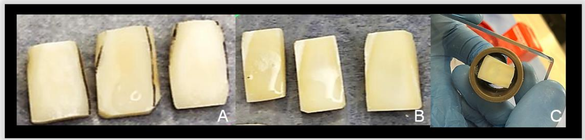
Figura 3 – Avaliação visual das superfícies após polimento. (A) abrasão da face vestibular das coroas limitada ao esmalte. (B) abrasão da face vestibular das coroas limitada a dentina. (C) avaliação visual das superfícies planificadas com o auxílio de uma placa de vidro.
