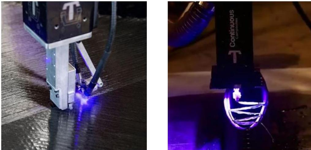
Figura 1.3 – Impressão de compósitos em fibra de carbono [adaptado de *continuous composites*].
