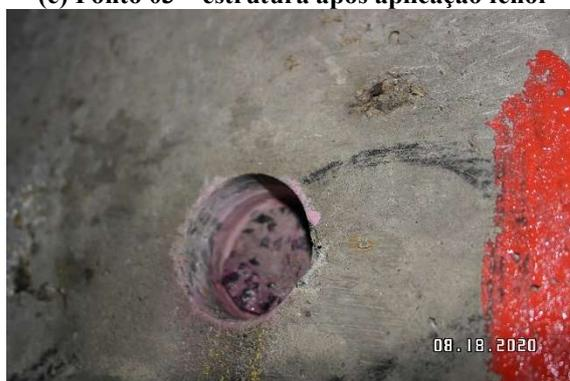
**(g) Ponto 04 – estrutura após aplicação fenol**
