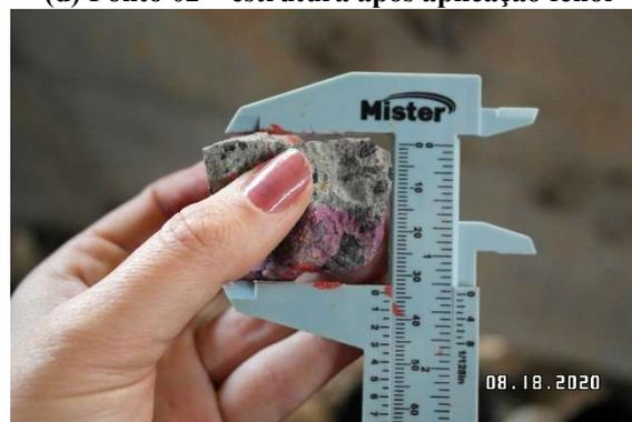
**(f) Ponto 03 – CP rompido após aplicação fenol**
