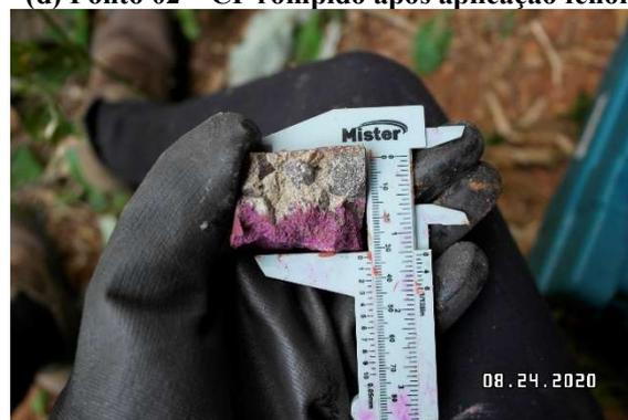
**(f) Ponto 03 – CP rompido após aplicação fenol**
