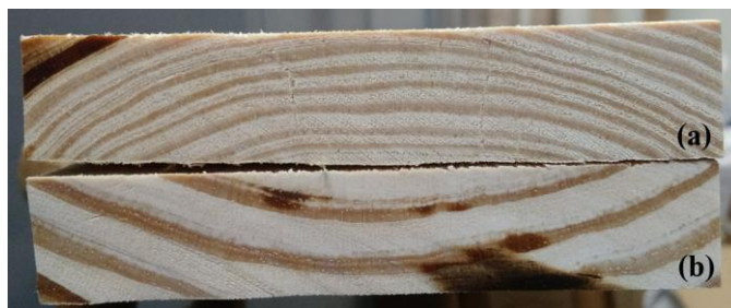
Figura 36 – Seção transversal de duas lamelas do lote 1 de madeira: (a) lenho maduro; (b) lenho juvenil
