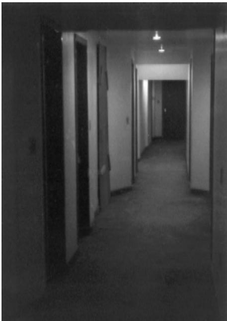
**FIG. 8** Iluminância de acordo com as normas NBR 5412/92, porém revelando um ambiente pobre visualmente, uniforme e sem atrativos.
