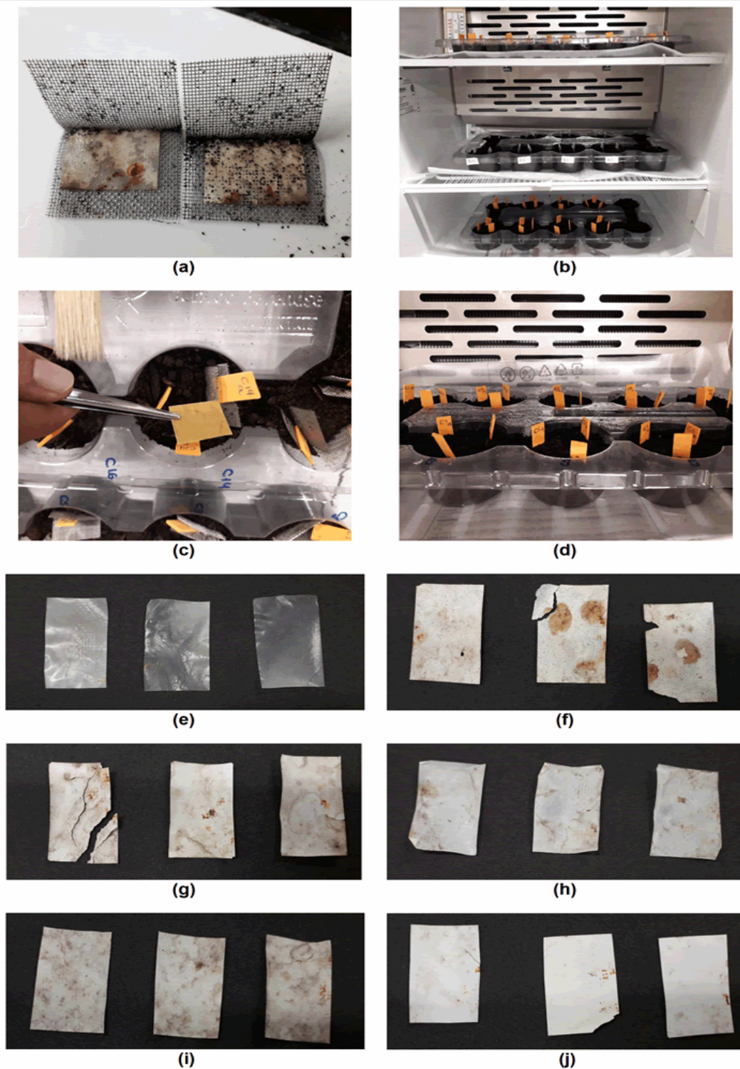
Figura 52 (a) Porta amostra de tela em inox (1mm); (b) Estufa; (c) e (d) amostras em triplicata; Amostras dos filmes após 45 dias: (e) PLA; (f) P(3HB); (g) PLA+P(3HP); (h) PLA+P(3HBcoHP); (i) P(3HBcoHV) e (j) PLA+P(3HFB)
