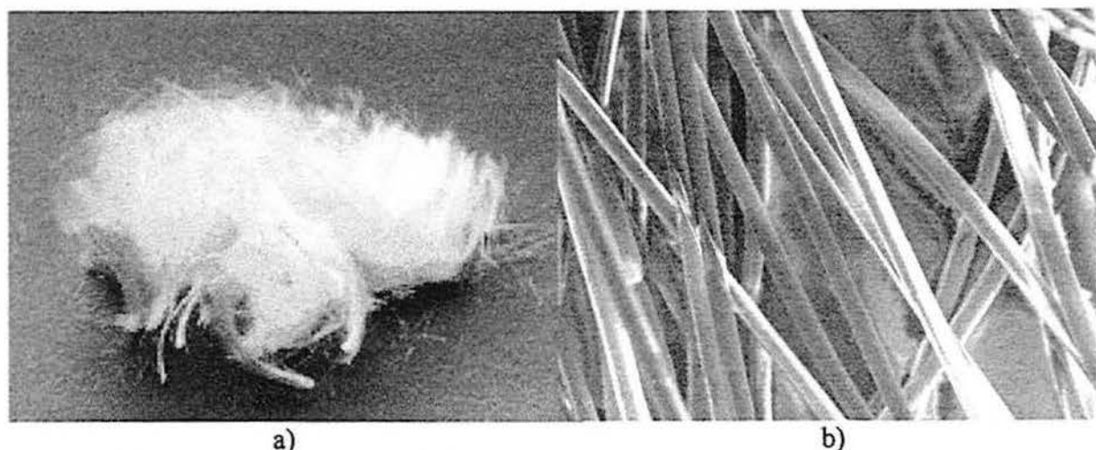
Figura 3.8: (a) Fibras de polipropileno cortadas em comprimentos de 24 mm. (b) Imagem de MEV por elétrons secundários das fibras de polipropileno (aumento de 230x).
