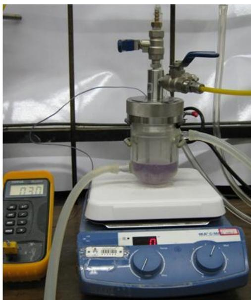
**Figura 4.16** – Imagem do reator de vidro utilizado nos testes de reciclo de oligomerização do eteno.
