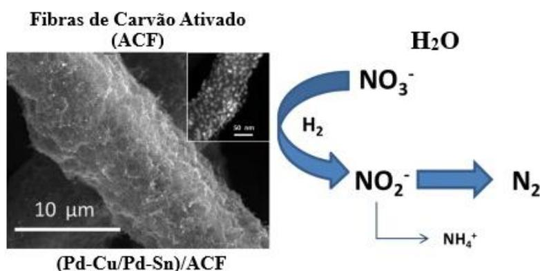
**Figura 2.18** – Representação das fibras de carvão ativado com Pd-Cu/Pd-Sn suportados em sua superfície e aplicados em reações de hidrogenação de nitrato. Adaptada<sup>78; 79</sup>.
