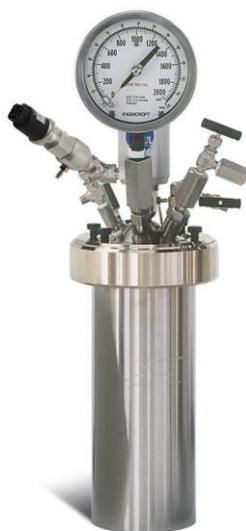
**Figura 4.15** – Imagem do reator Parr de aço inoxidável, utilizado nas reações de oligomerização do eteno.
