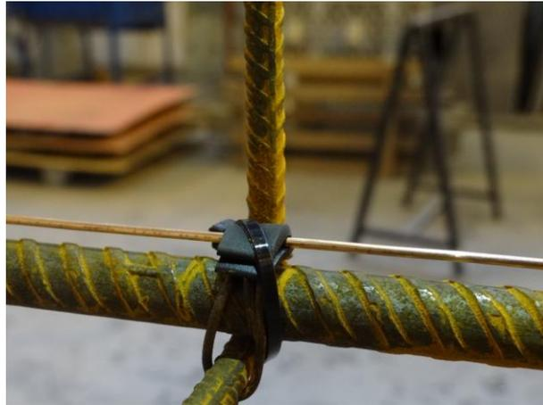
Figura 19: Posicionamento do eletrodo de corrosão
