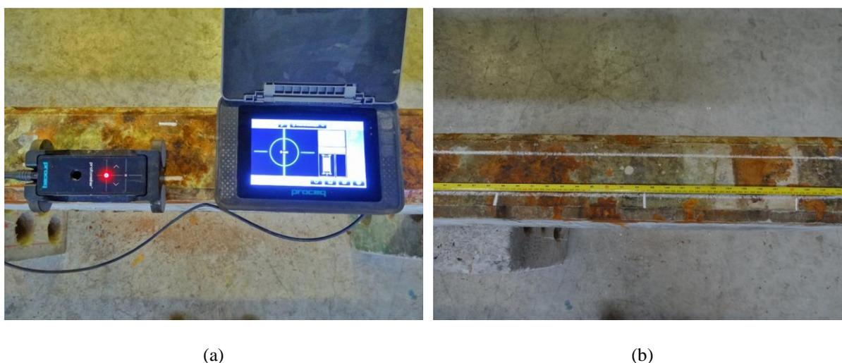
Figura 23: Localização das armaduras por pacometria e marcação do grid de leitura para avaliação por END
