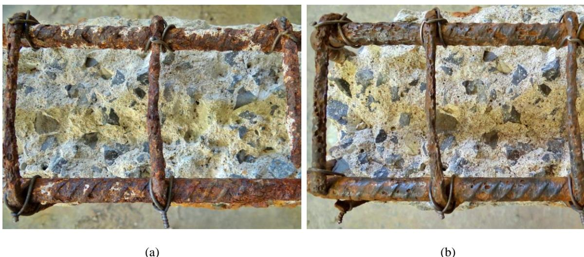
Figura 35: Armadura com produtos de corrosão (a) e a armadura com os produtos removidos (b)
