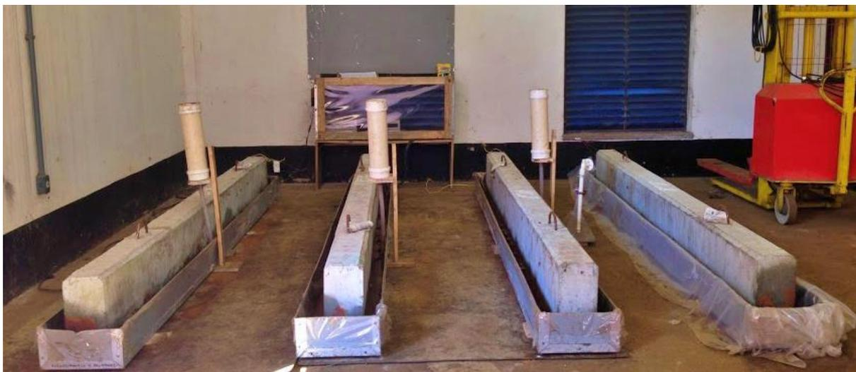
Figura 18: Execução da aceleração da corrosão nas vigas de concreto armado
