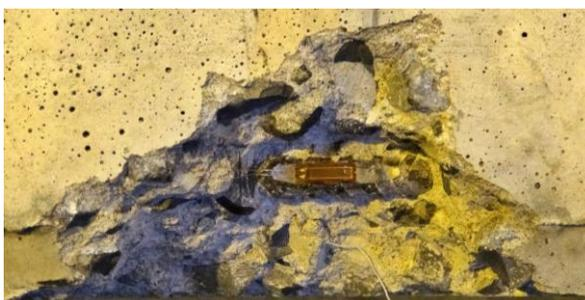
Figura 52: Abertura realizada na viga com extensômetro colado na armadura
