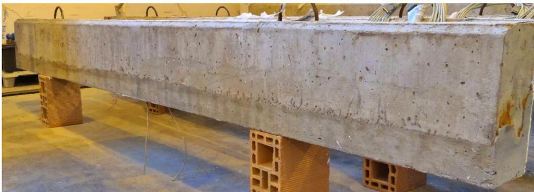
Figura 42: viga já recuperada com o Concreto Têxtil
