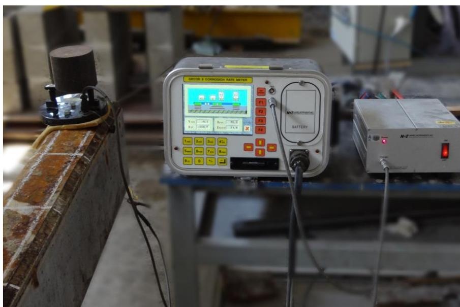
Figura 25: Determinação da taxa de corrosão com o equipamento Gecor 8
