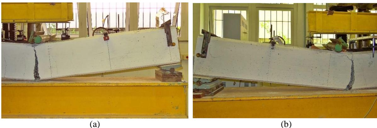
Figura 68: Modo de ruptura das vigas com 5% de corrosão (a) e com 10% de corrosão (b)
