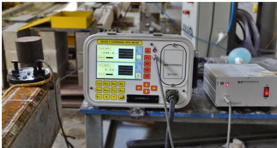
Figura 24: Determinação do potencial de corrosão com o equipamento Gecor 8
