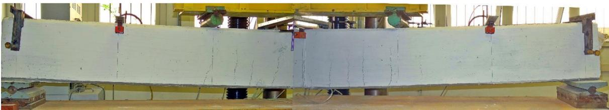
Figura 67: Quadro geral de fissuração das viga sem corrosão
