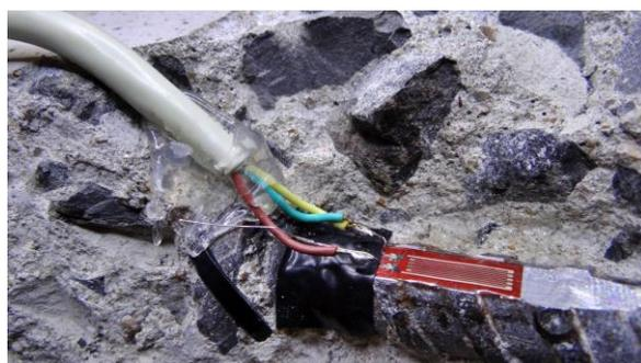
Figura 53: Ligação do extensômetro das armaduras com o cabo de aquisição de dados
