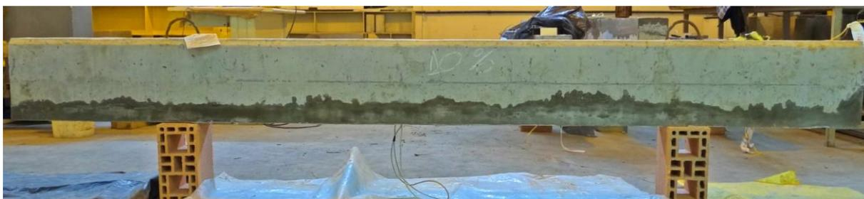
Figura 38: Viga recuperada com o UHPFRC
