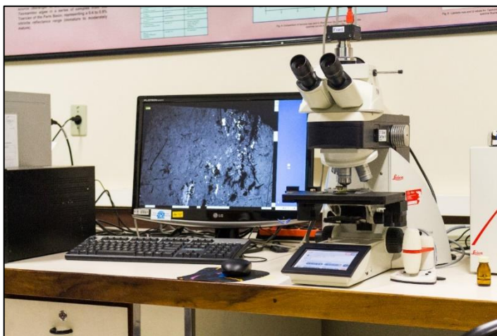
Figura 14: Microscópio Leica DM6000M utilizado para análises petrográficas.
