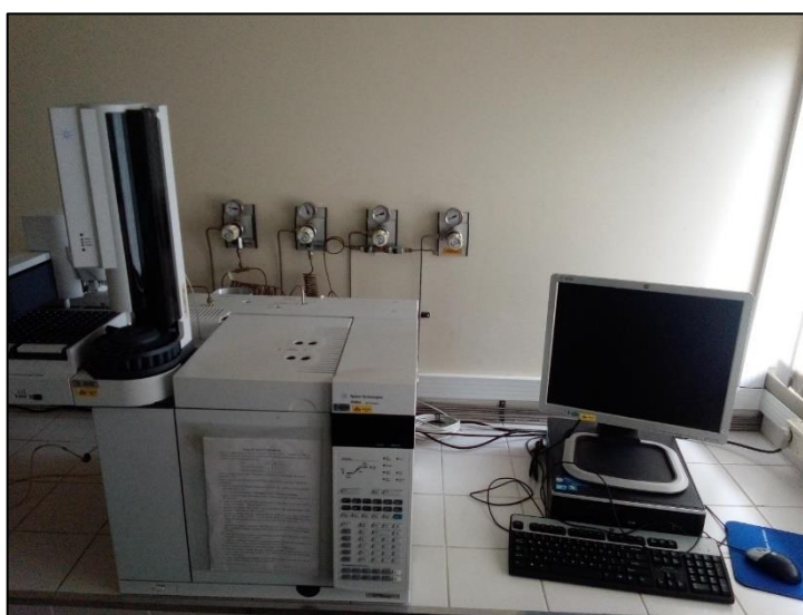
Figura 12. Cromatógrafo Gasoso Agilent Technologies 7890 (Núcleo de Estudos de Carvão e Rochas Geradoras de Petróleo/IGEO/UFRGS).
