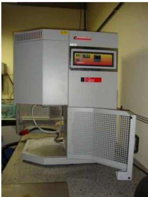
Figura 11- Forno da marca Carbolite, utilizado para decarbonatação.
