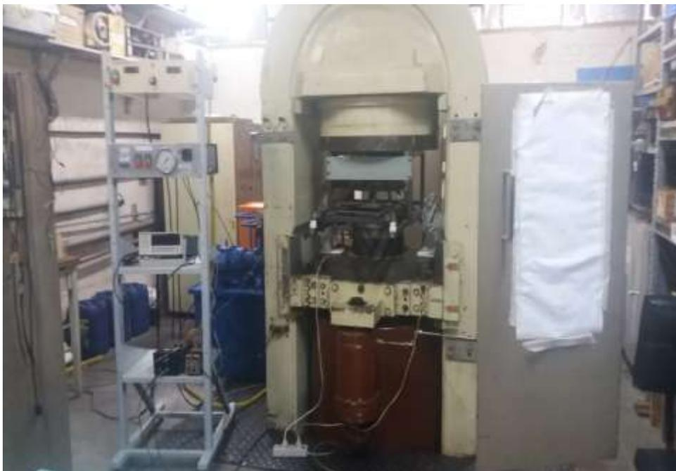
Figura 15- Imagem da prensa hidráulica usada nos experimentos. Nas estantes à direita ficam os controladores de pressão e temperatura, bem como o sistema de aquisição de dados.
