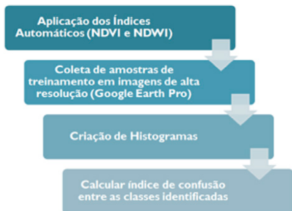
Figura 34. Fluxograma do processo metodológico de avaliação da integridade das margens como indicador de qualidade ambiental das lagoas. Fonte: elaborado pelos autores
