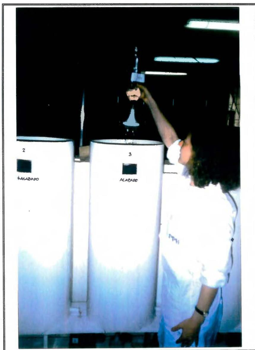
**Figura 4.5-** Sistema de rega dos lisímetros
