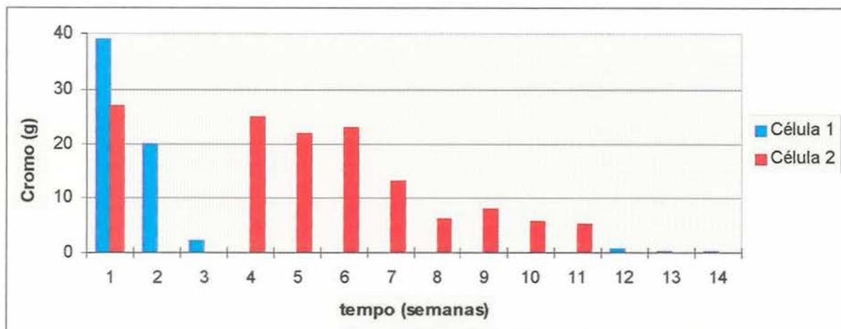
Figura E.25-Variação da carga de cromo (g) nos percolados das células de aterro sanitário
