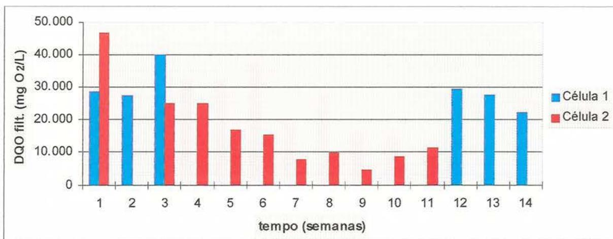
Figura E.14-Variação da concentração de DQO filtrada (mg O<sub>2</sub>/L) nos percolados das células de aterro sanitário
