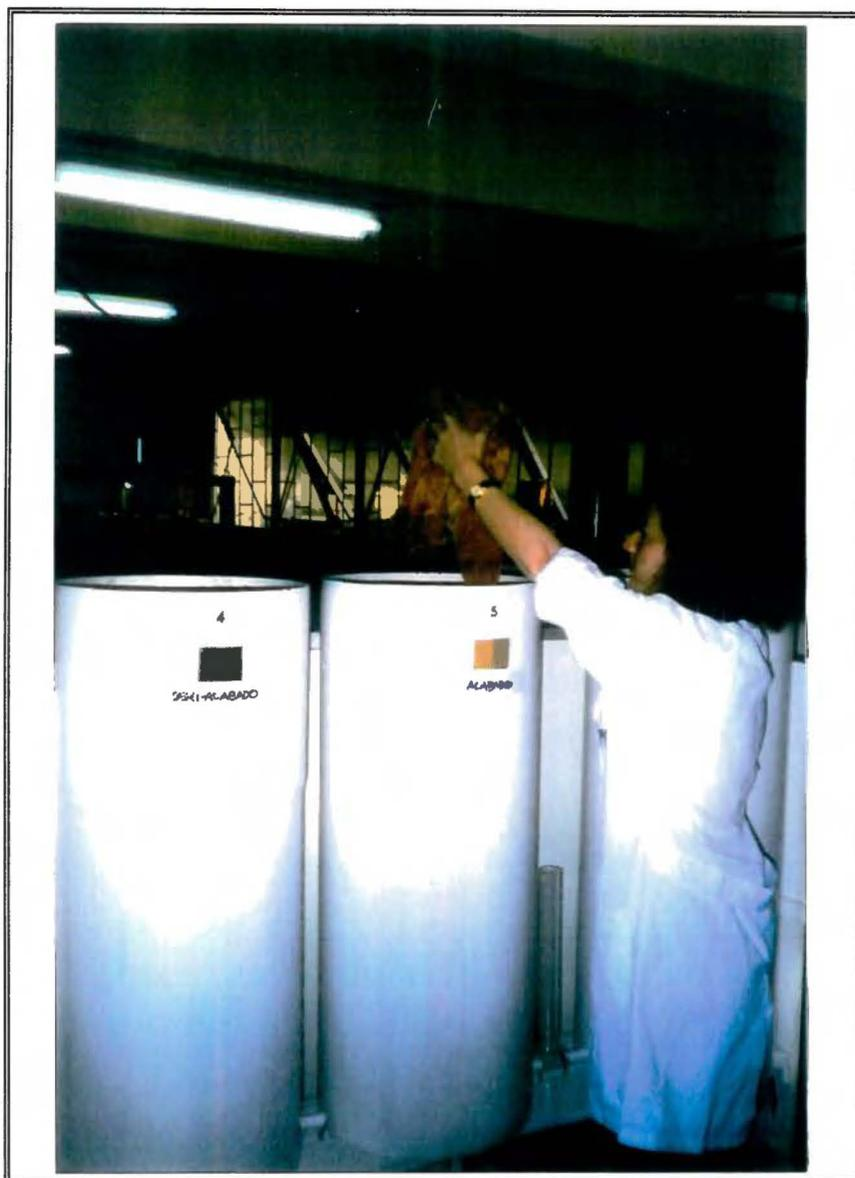
**Figura 4.4-** Detalhe da colocação das aparas de couro nos lisímetros
