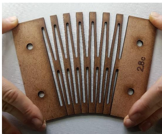
Figura 57 - Fotografia ilustrativa dos movimentos parasíticos existentes em amostras com Índice 1=2.
