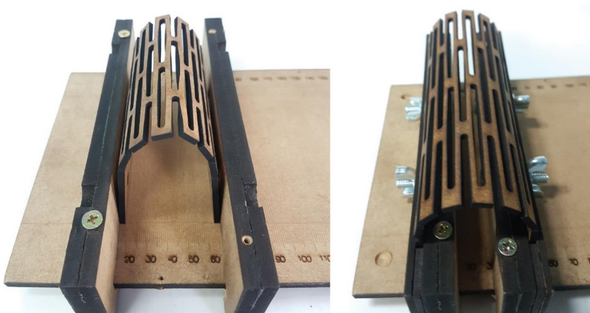
Figura 81 - Exemplos do resultado de curvamento para amostras com diferentes larguras.
