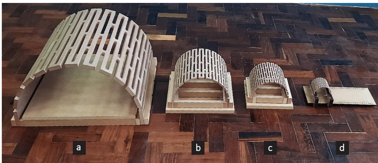
Figura 52 - Foto de uma amostra de cada espessura do teste F posicionada no seu respectivo suporte.
