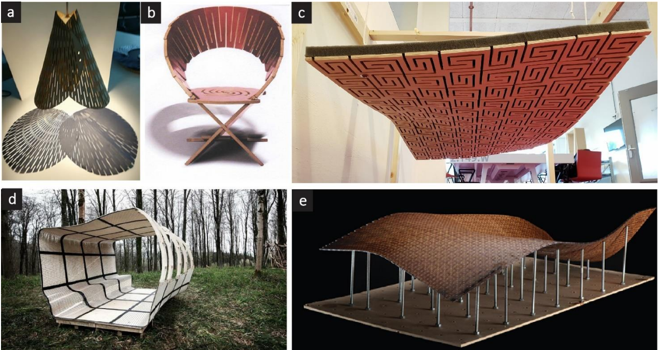
Figura 10 - Exemplos de aplicações da técnica de kerfing .
