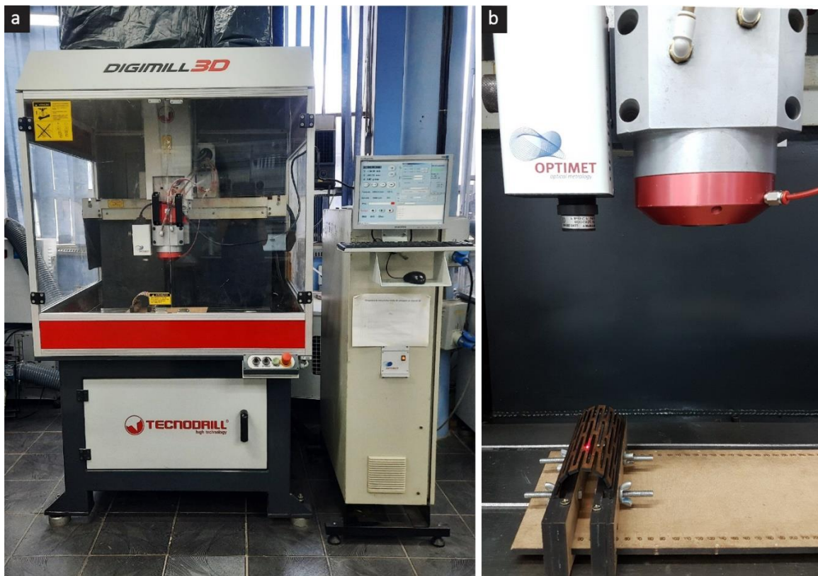
(a) Conjunto do equipamento de digitalização Digimill 3D (b) cabeçote de digitalização com incidência do laser na peça para captação dos pontos. Fonte: da autora (2021).
