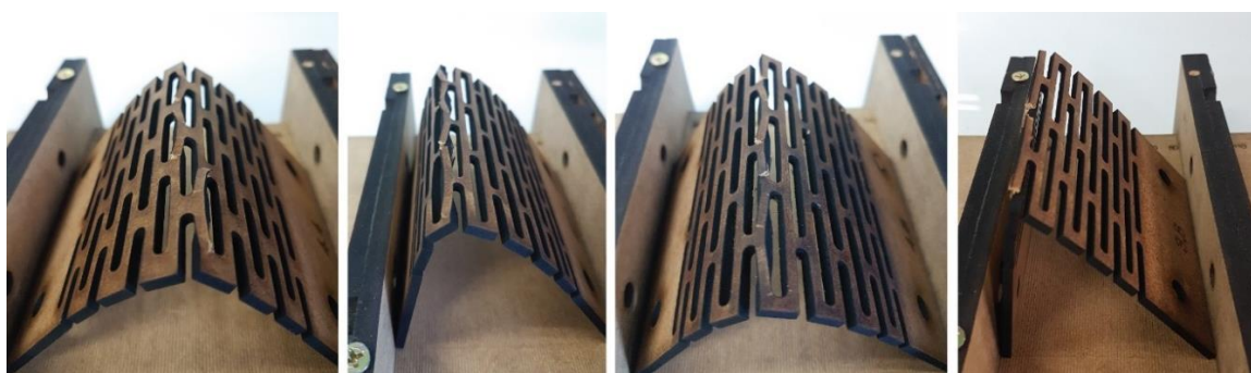
Figura 58 - Fotos do momento de rompimento de algumas amostras.
