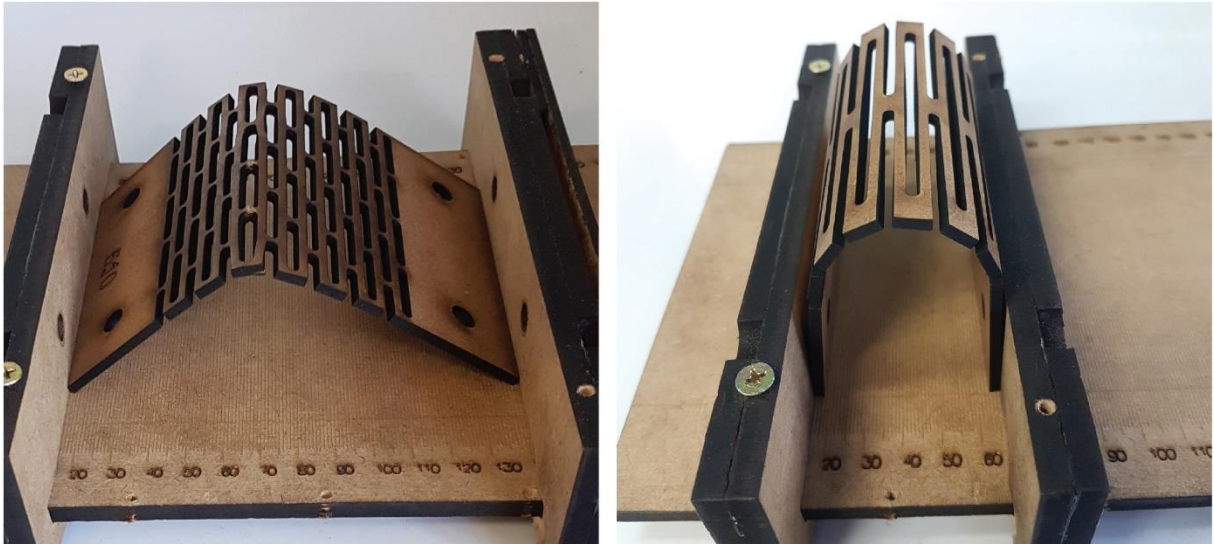
Figura 79 - Exemplo do resultado de curvamento para amostras com diferentes quantidades de segmentos perpendiculares ao eixo de flexão.
