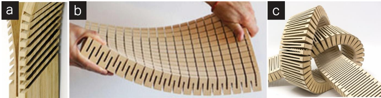
Figura 15 - Tipos de kerfing por face de aplicação.
