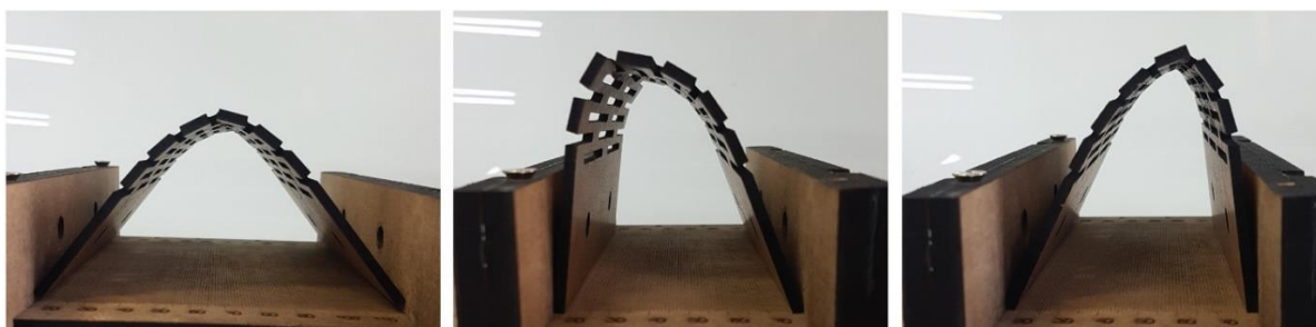
Figura 59 - Fotos de amostras que conformaram diferentes geometrias de arcos.
