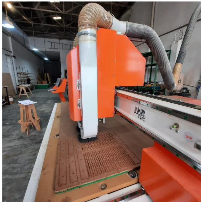
Figura 50 - Corte das amostras de 6 mm na fresadora CNC.
