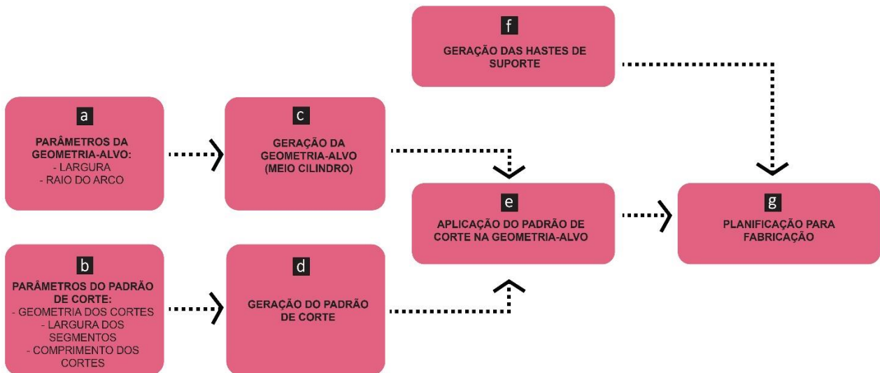
Figura 37 - Fluxograma do algoritmo de geração da geometria e planificação da amostra.
