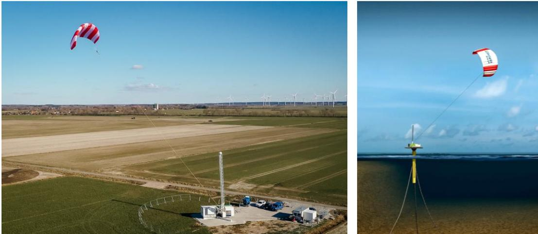
Figura 1.2: Sistema AWE de sustentação com pipa tipo Foil. Observa-se que a base é pequena e a unidade de potência cabe em um contêiner padrão. Na direita o sistema opera offshore. Retirado de <https://skysails-power.com/onshore-units/> e Fonte:
