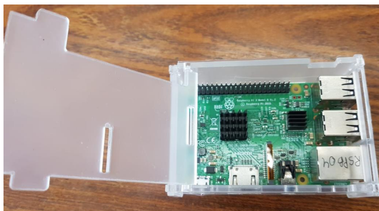
Figura 19: Foto do Raspberry Pi 3 da aplicação com dissipador e case.
