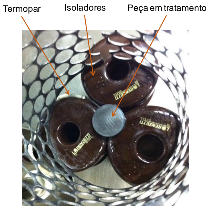
Figura 20 – Detalhe da montagem da amostra nos isoladores.
