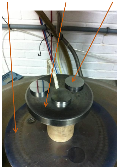
Figura 31 – Amostras montadas na mesa auxiliar.
