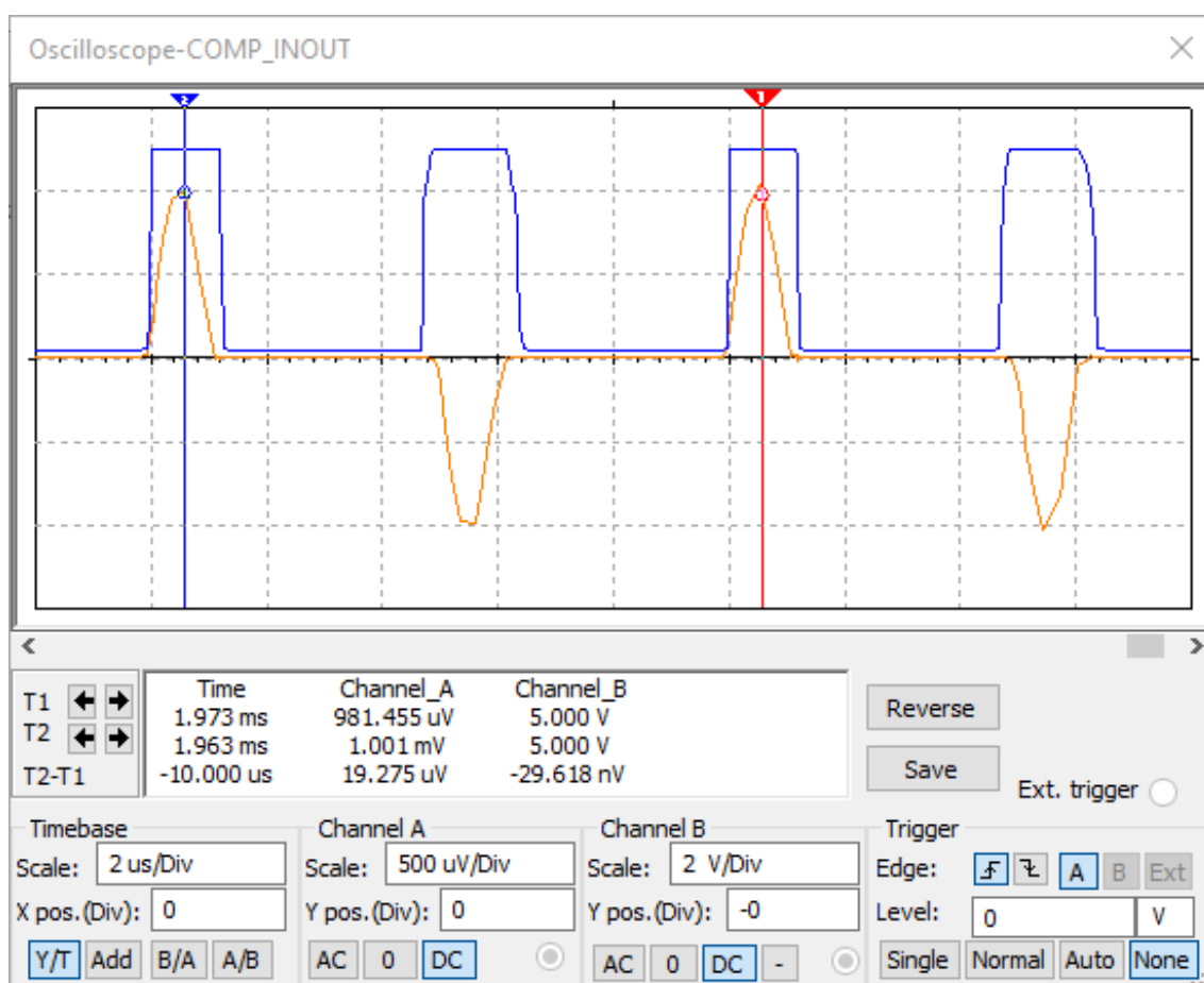
Figura 31: Representação gráfica da relação entre a corrente do secundário e a saída do comparador.
