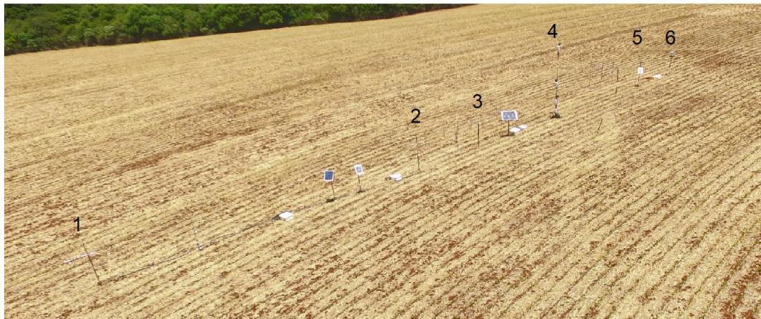
Figura 5. Foto da área experimental: a) vista aérea por drone com a localização dos sensores e instrumentos meteorológicos instalados (1, 2 e 3 Sensores de NDVI e Ts; 4 Torre micrometeorológica; 5 Saldo radiômetro e Rg; 6 Pluviômetro) e b) foto mostrando com detalhe os com sensores instalados.
