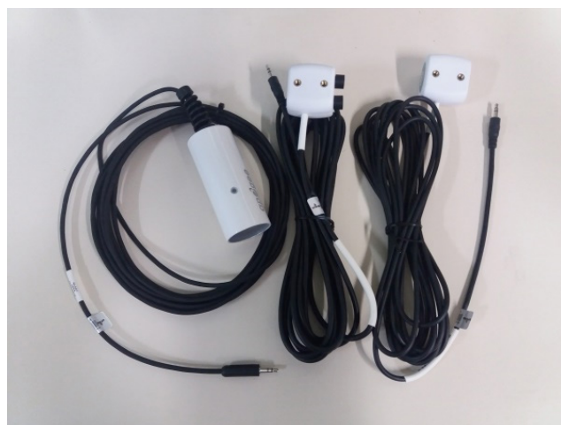
Figura 2. Sensores utilizados nas medições durante o experimento para a cultura da soja na safra de 2017-2018. Da direita para esquerda: sensor de NDVI hemisférico, sensor de NDVI direcional SRS, marca Decagon e sensor de temperatura radiométrica ( T_s ), modelo SI 421, marca Apogee. Carazinho - RS, 2018.
