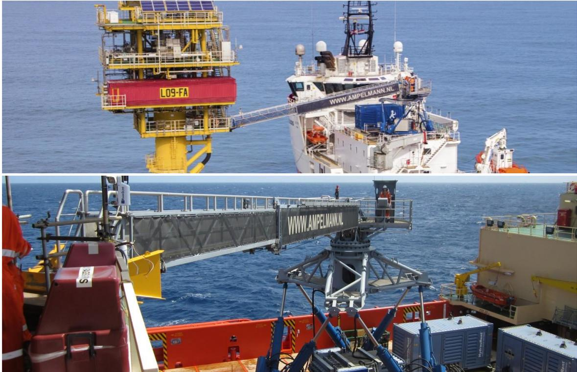
Figura 2.4 – Sistemas de compensação de movimentos de navio Ampelmann do Tipo- $A^{EP}$  (imagem superior) e Tipo- $E$  (imagem inferior) [Ampelmann, 2020].
