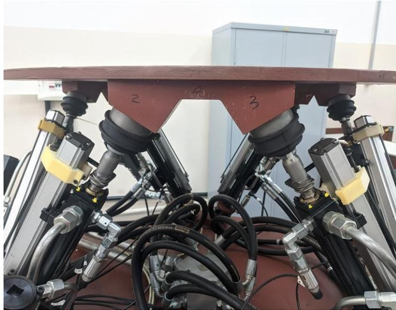
Figura 6.1 – Juntas esféricas e suportes angulares da plataforma móvel.
