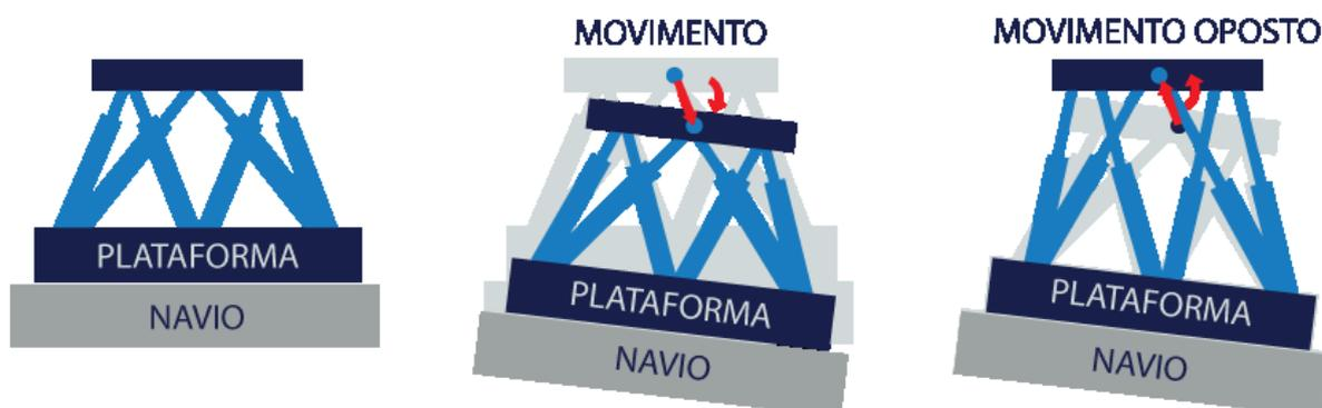
Figura 1.2 – Funcionamento de um sistema de compensação de maré [Valente, 2016].
