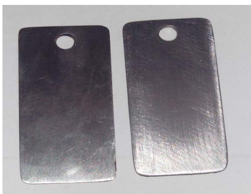
Figura 8 – Placas de aço 1020 polidas.
