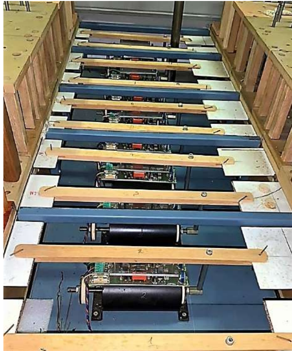
Figura 29 – Solenóides conectados às corredeiras.
