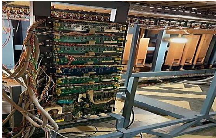
Figura 27 – Central elétrica do órgão da Capela São José.
