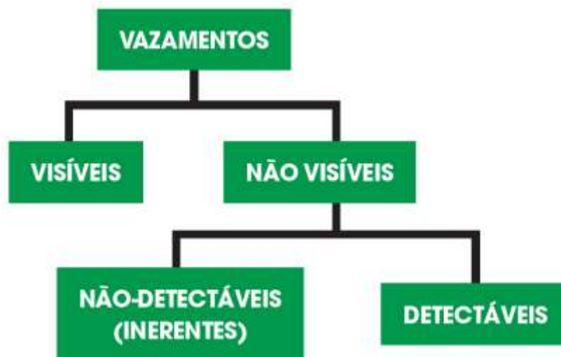
Figura 3 - Classificação dos vazamentos segundo a IWA
