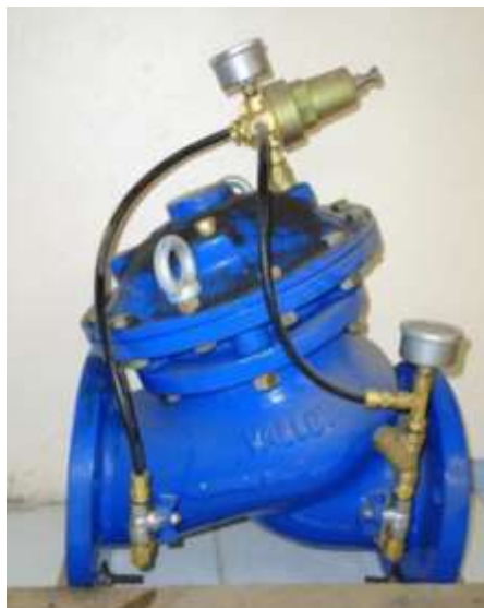
Figura 6 - Válvula redutora de pressão
