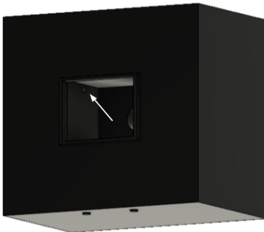
Figura 18.B - Vista frontal inferior da célula onde ficará o fluido contaminado. Seta branca mostrando a saída de ar.
