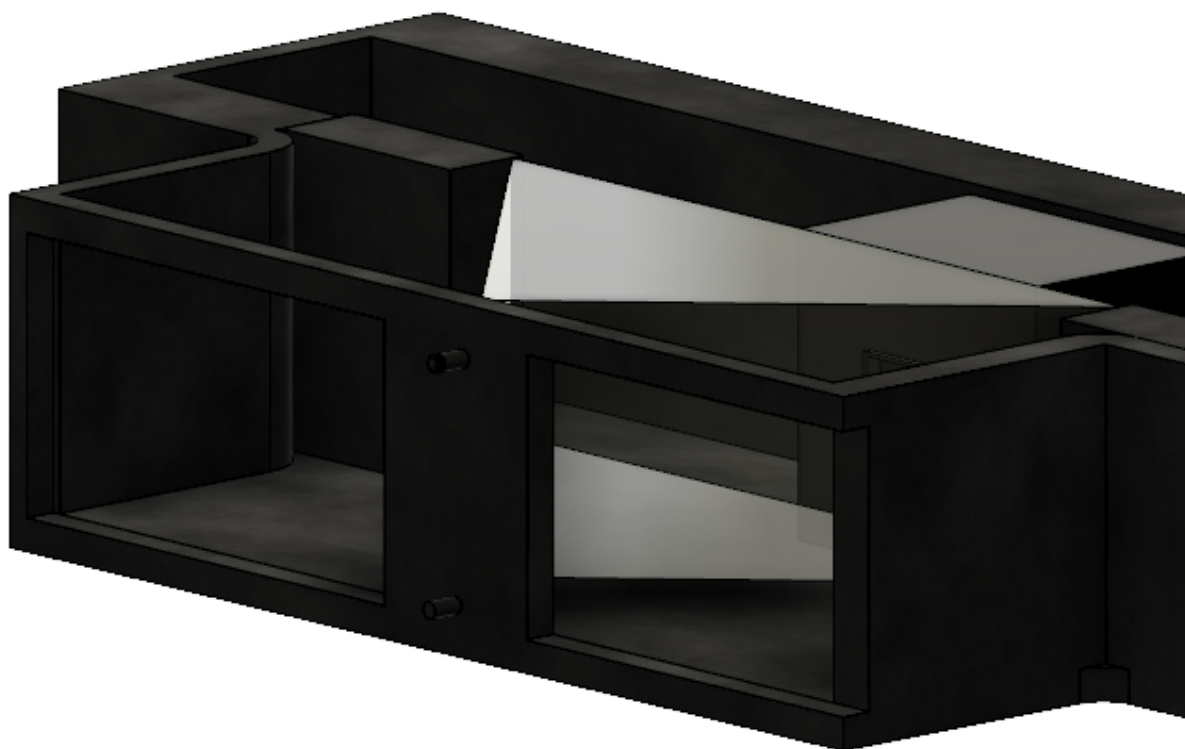
Figura 14 - Detalhes da parte frontal de contato mostrando o prisma e os detalhes do encaixe mecânico na base.
