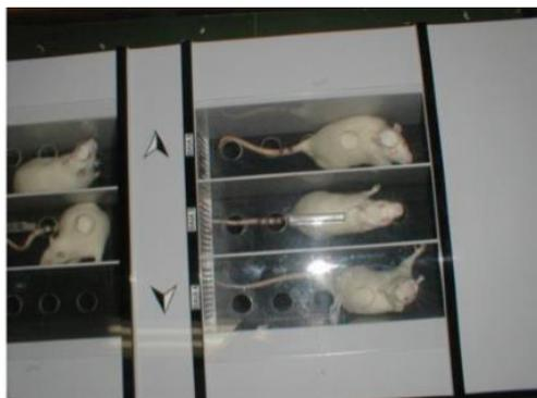
**Figura 10. Foto ilustrativa da esteira ergométrica adaptada para ratos INSIGHT®.** Visão superior do equipamento subdividido em 6 ambientes, permitindo a realização do treinamento de no máximo 6 animais simultaneamente. Fonte: Nicola (2017).
