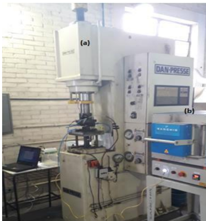
Figura 33 – (a) Prensa de duplo efeito Dan-Pressé (b) forno utilizado para aquecimento dos corpos de prova SANCHIS FORNOS INDUSTRIAIS.
