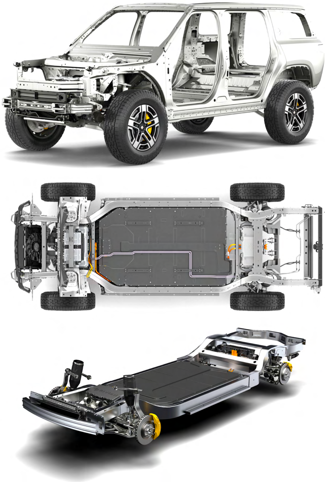
FIGURA 5.5. Exemplo: Chassi Monobloco e Suspensão Independente Multilink.
