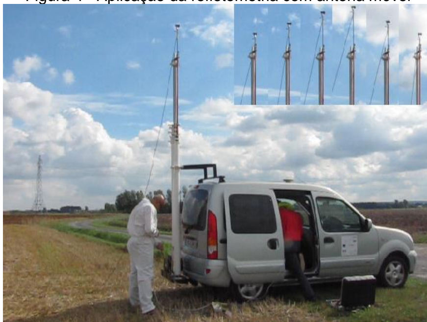
Figura 4 - Aplicação da refletometria com antena móvel
