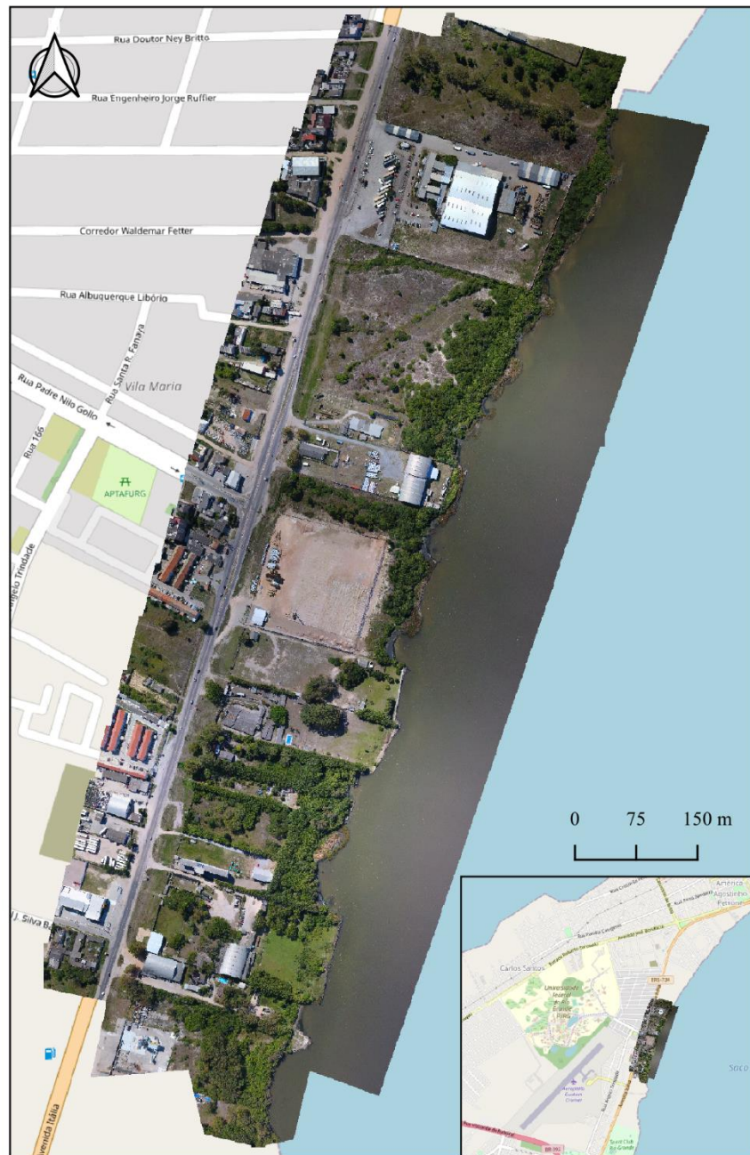
Figura 15 - Mosaico realizado a partir do aerolevanteamento por VANT. Fonte: O autor.
